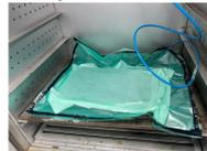
Placas prensadas em bolsa de vácuo:
